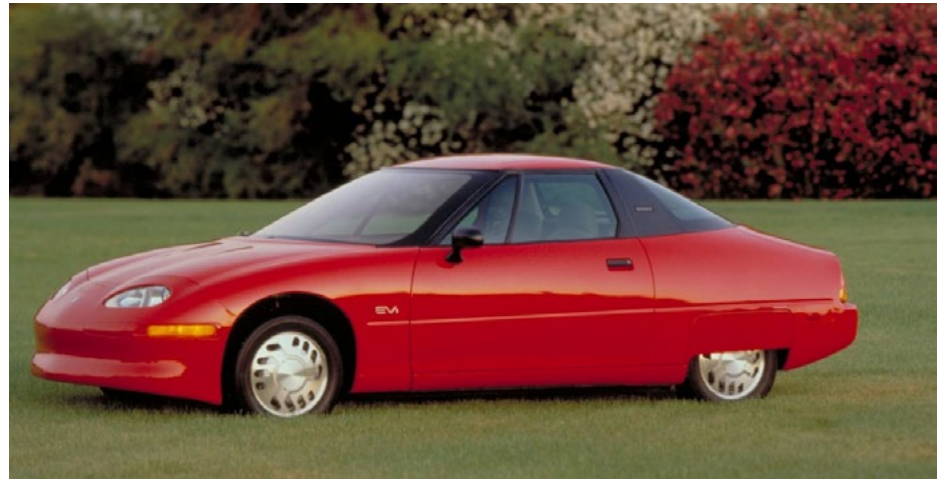
Lohner Porsche 1900, uitgevoerd met een electromotor per wiel. [R] GM Chevrolet EV1 c. 1990, een experimentele elektrische auto.
